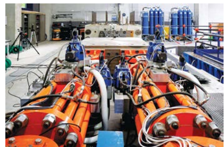
Sistema di prova per smorzatori (DTS) Damper Testing System
